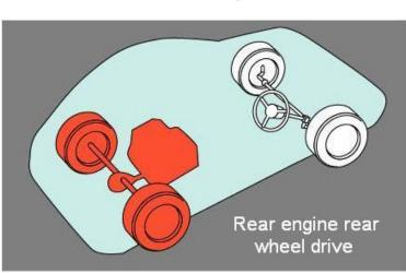
في هذا النظام يكون وضع المحرك في مؤخرة السيارة (مكان حيز الأمتعة الخلفية )، وتكون العجلتين الخلفيتين هما هما المديرتان ، والعجلتين الأماميتين مدارتان (متدحرجتان). وفي هذا النوع يكون حيز الأمتعة في مقدمة السيارة ، ويستخدم المحرك في هذا النظام التبريد الهوائي (عن طريق ضاغط هوائي) بديلا عن الردياتير.
